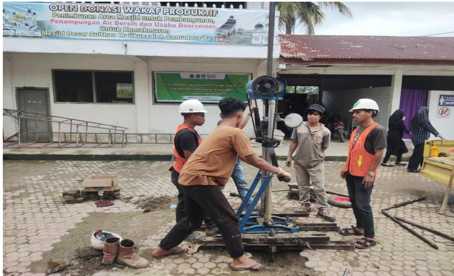
Gambar A.3 Sondir Pada Titik 1 dan Titik 2
