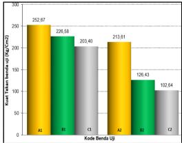
Gambar 3. Grafik hubungan hasil pengujian kuat tekan dengan variasi benda uji
