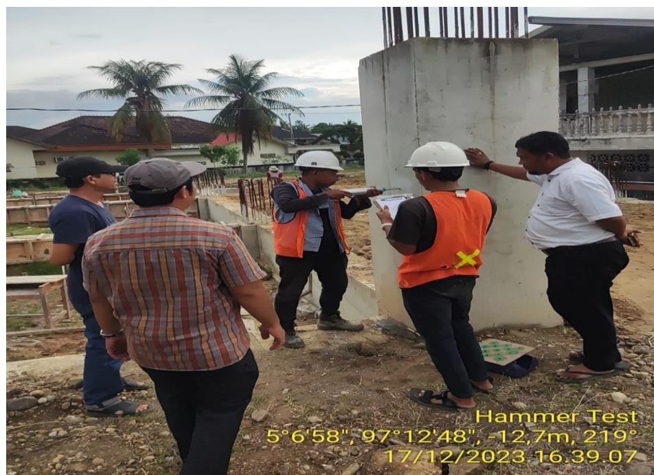
Gambar 3.11 Tahap ketiga melakukan pengujian pada kolom
