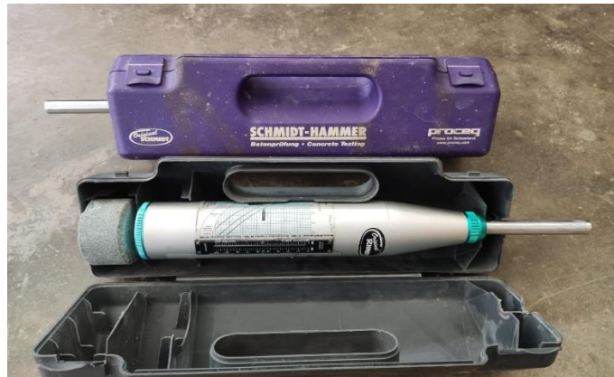
Gambar 3.6 Alat Uji Hammer Test
